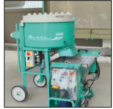
Alimentada por una mezcladora planetaria con doble sentido de giro, para múltiples tipos de materiales (Mezcladora IMER modelo MIX-120)
