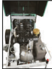
Motor Diesel Yanmar de 35 Kw, 4 cilindros. Acoplamiento directo motor a compresor
