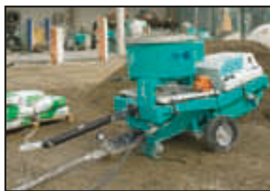
La mezcladora planetaria con doble sentido de giro es “opcional”. Principalmente es utilizada para la mezcla de morteros premezclados y también para la mezcla de morteros monocapa
