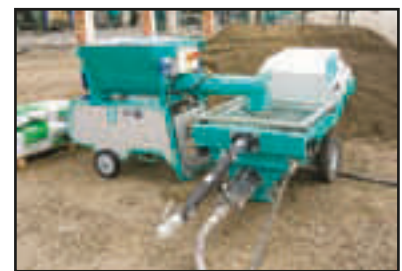
La STEP-120 puede ser también alimentada por un mezclador continuo, para mezclar multiples tipos de materiales (Mezclador continuo IMER modelo SPIN-30 “PLUS”)
