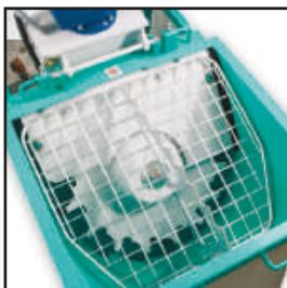
Noria con celdas en el interior de la tolva
