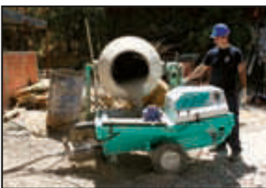
Alimentada por una hormigonera que principalmente es utilizada para realizar mortero tradicional. (Hormigonera IMER modelo SYNTESI)
