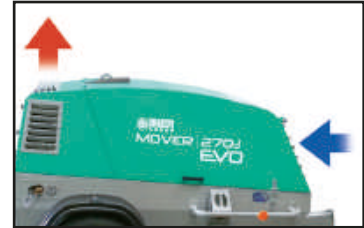
Sistema de refrigeración de flujo rápido (FAST-FLOW)
