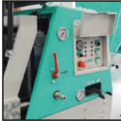
Cuadro de comando y control de mandos neumáticos centralizados
