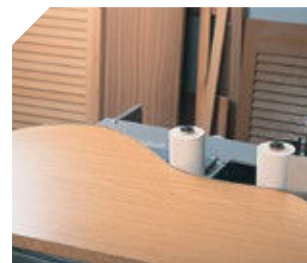
Aplacado de piezas curvas.
