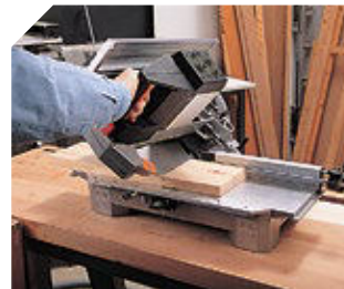
Cabezal abatible de 0° a 45° y orientable de 0° a 45°.
