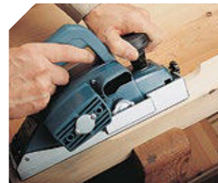
Especialmente diseñado para el achaflanado de cantos.
