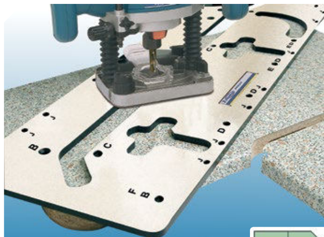
Fresado cruciforme para la unión de las dos partes de la encimera.
