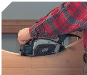
Cepillado de superficies cóncavas.
