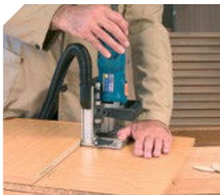
Ensamblaje en medio del tablero
