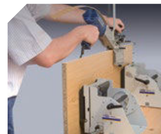
Sujetar piezas grandes con ayuda de una unidad auxiliar SVN470 (SVN460) o SVE680 (SVE660).
