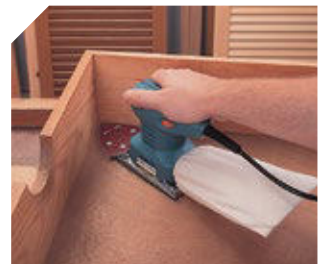
Con la base delta, lijar en esquinas interiores resulta fácil y cómodo.
