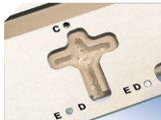
Fresado cruciforme para la unión de las dos partes de la encimera.
