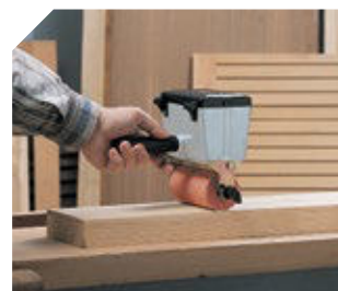
Encolado con colas vinílicas (blancas).
