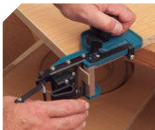
Retestado del sobrante de ambos extremos en paneles rectos.
