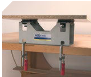
Firme fijación de las piezas. Sujeción al banco de trabajo mediante los sargentos incluidos.
