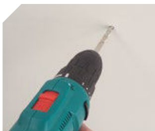
Portabrocas de sujeción rápida.
