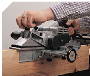
Escuadra micrométrica que permite realizar cepillados inclinados a distintos grados.
