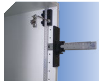
Taladrado para la colocación de bisagras invisibles.
