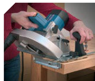
Realizando corte a inglete.
