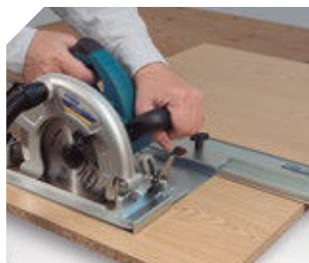
Cortes con el soporte 7446879 y el riel UCP90, ambos opcionales.
