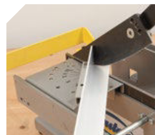
Extremo de la cuchilla biselado para el corte a medida de canalones en PVC
