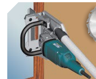
Recorte del marco de madera de la ventana. Registro sobre la escuadra frontal regulable.
