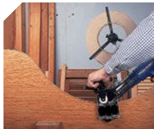
Aplacado de piezas circulares o con formas.
