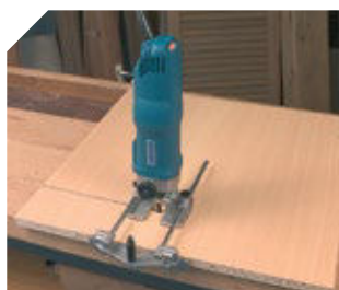
Fresado de regatas paralelas con guía lateral.
