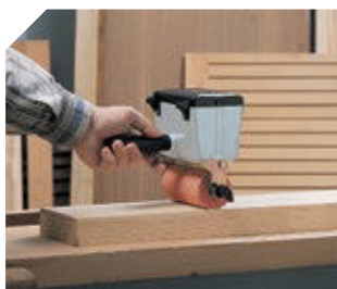
Encolado con colas vinílicas (blancas).
