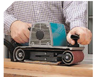
Lijado uniforme y sin surcos.
