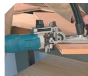
Perfilando el canto usando el filo de la fresa cilíndrica incluida.
