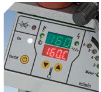
Regulación de la temperatura (120 a 200°C) controlada por microprocesador para una mayor exactitud en la medición. Sistema de elevación de la temperatura por impulsos. Protege las resistencias y aumenta su durabilidad.
