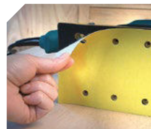
Dos sistemas de sujeción del abrasivo: mediante pinza o velcro (incluido de origen).
