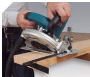
Realizando corte a inglete.
