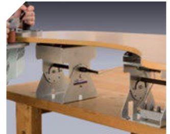
Sujeción de una pieza de grandes dimensiones con una unidad auxiliar SVN470 (SVN450) o SVE680 (SVE670).
