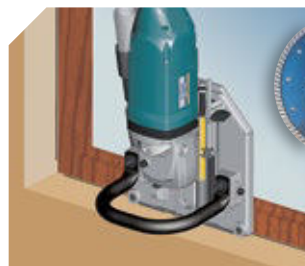
Corte de la obra con el disco de diamante, para la extracción el marco completo. Registro por el frontal recto de la base reversible.
