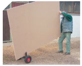
Transporte de un panel de grandes dimensiones por un suelo irregular.
