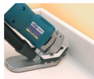
Primer fresado con la fresa de radio 10 mm.
